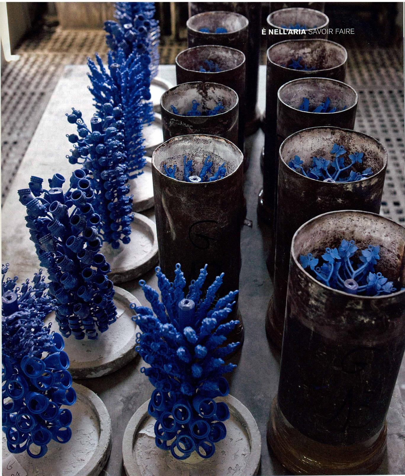
I grappoli di cera sono pronti per essere inseriti nei cilindri in acciaio, dove viene versato il gesso liquido. Proprio con la sua solidificazione si ricava lo stampo dentro al quale, una volta fusa, la cera si perde nei canali di svuotamento per lasciar posto all'argento: è l'antica tecnica detta, appunto, della cera persa.
