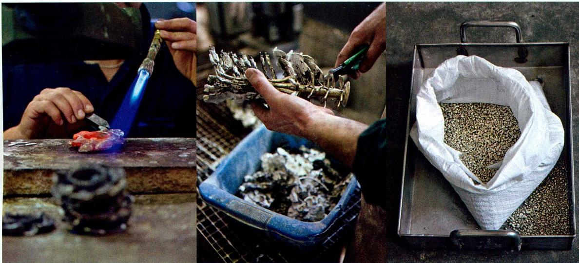
Siamo nelle ultime fasi di lavorazione, quelle di saldatura e ripulitura.
