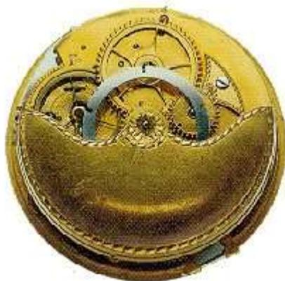
Sotto la massa oscillante, come si vede nella figura, era fissato un disco intagliato (d) che serviva per arrestare la massa oscillante quando l'orologio raggiungeva la massima carica, per impedire rotture della molla o degli ingranaggi.
