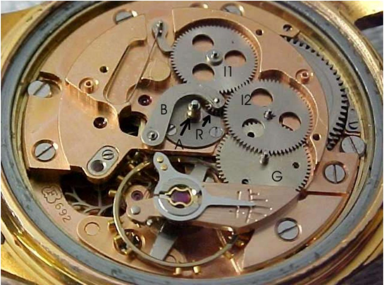
La ruota (G), che nel disegno sotto è rovesciata, nella parte inferiore era dotata di una molletta (M) solidale al pignone che ingranava il rocchetto del bariletto. La conformazione della molletta (rossa) permetteva il suo scivolamento rispetto alla ruota (verde) quando l'orologio veniva caricato manualmente, mentre impuntandosi nei fori della ruota stessa permetteva il suo avanzamento, e quindi la carica della molla, quando la massa oscillante ruotava.
