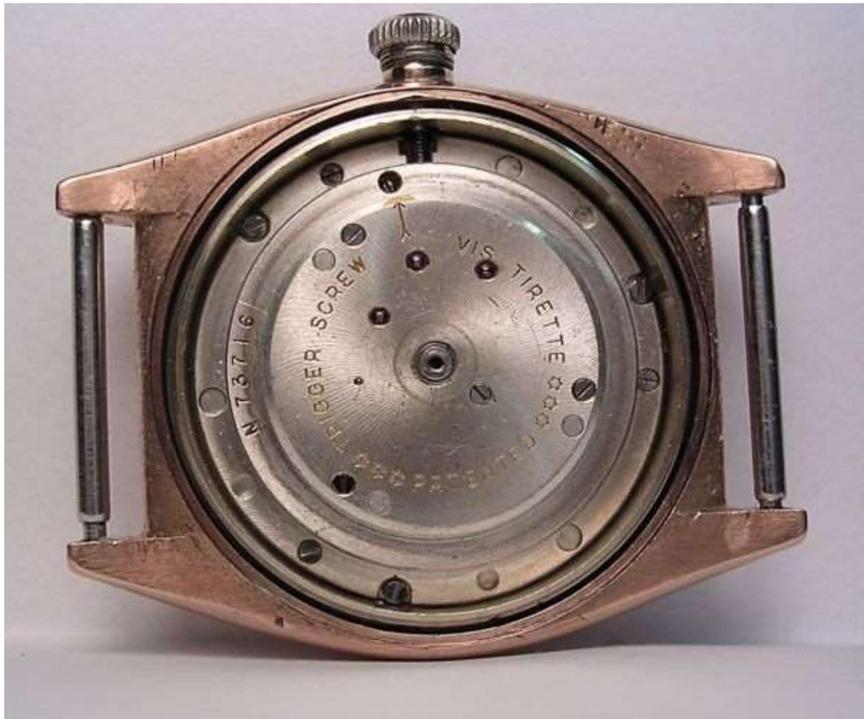
In questa foto, dove è stata levata la platina superiore del dispositivo di carica automatica, possiamo vedere il treno demoltiplicatore, che consente la carica della molla anche con piccoli spostamenti del rotore.
