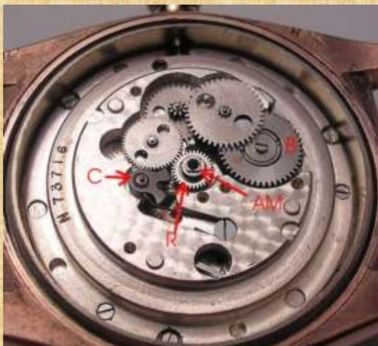
In questa foto, dove è stata levata la platina superiore del dispositivo di carica automatica, possiamo vedere il treno demoltiplicatore, che consente la carica della molla anche con piccoli spostamenti del rotore.
