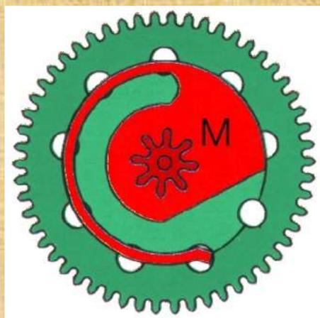
La ruota (G), che nel disegno è rovesciata, nella parte inferiore era dotata di una molletta (M) solidale al pignone che ingranava il rocchetto del bariletto. La conformazione della molletta (rossa) permetteva il suo scivolamento rispetto alla ruota (verde) quando l'orologio veniva caricato manualmente, mentre impuntandosi nei fori della ruota stessa permetteva
