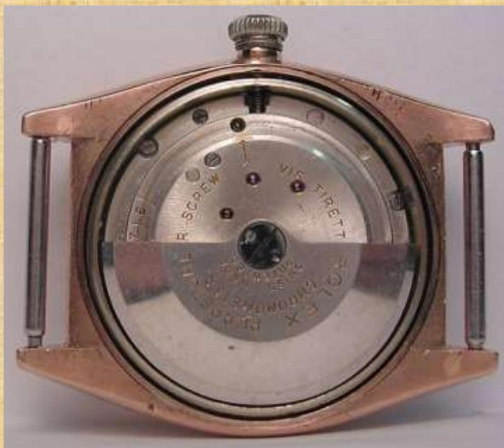
Ma esaminiamo nel dettaglio il dispositivo automatico. Qui possiamo osservare il movimento dopo che è stata levata la massa oscillante.
