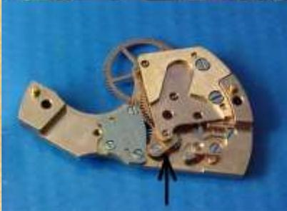
Un ulteriore sistema fu brevettato dalla IWC, il Pellaton: il sistema prevedeva una camma a forma di cuore, solidale alla massa oscillante, che faceva muovere due cricchetti che a loro volta attraverso altre ruote caricavano la molla.
